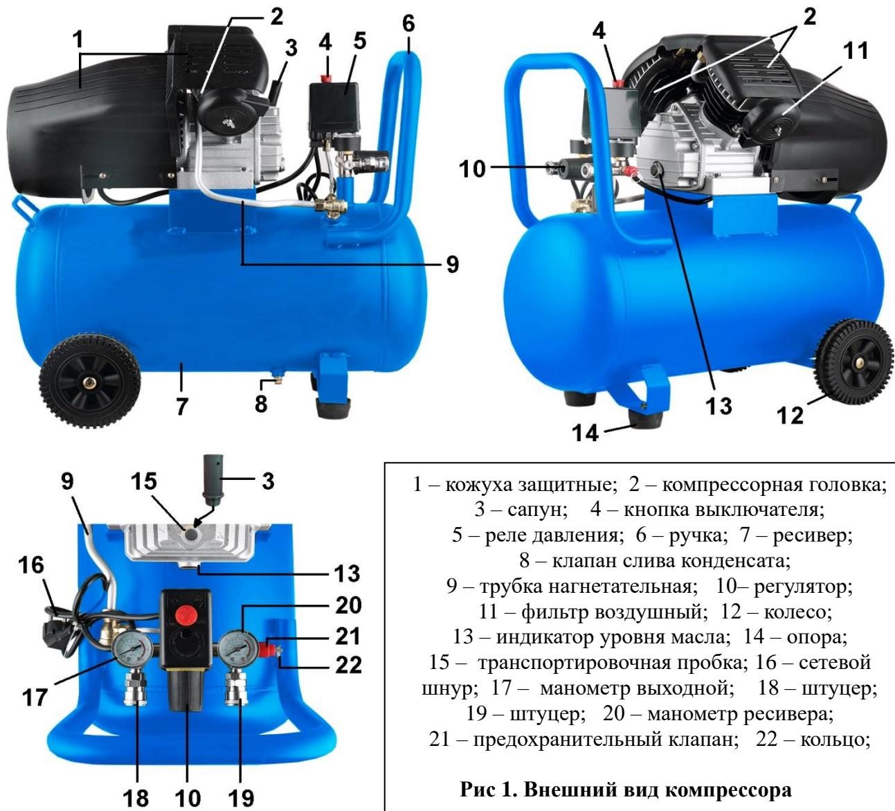
5.2.2. Каждая компрессорная головка оснащена фильтром воздушным поз. 11, которые служат для очистки воздуха от крупнозернистой пыли.
